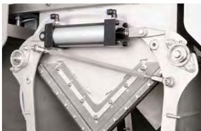
Compuerta de gravedad y tolva de pesaje en acero inoxidable con bisagra hidráulica.
